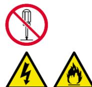
異臭（こげ臭いなど）や異常な音がしたら、ただちに電源スイッチを切り、電源プラグをコンセントから抜いてください。
