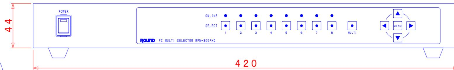
RPM-800FHD 外形寸法図
